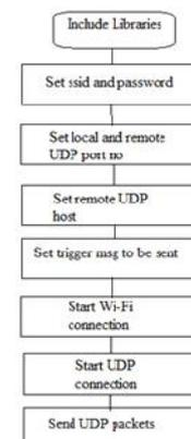
Fig. 4. Sender NodeMCU flowchart
